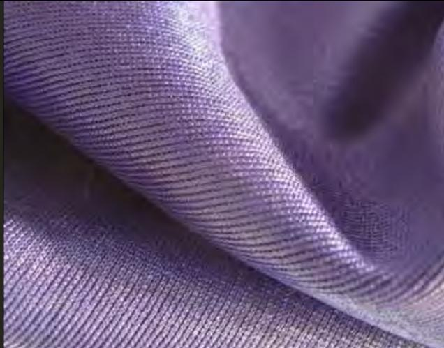
El nylon es una fibra completamente sintética conocida por su flexibilidad superior y excelente resistencia. Es una fibra bastante resistente que no la ataca la polilla y no necesita planchado.
