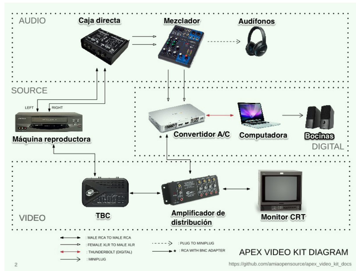
Diagrama de los componentes del kit de digitalización de APEX, útil para proyectos caseros o de menor escala.
