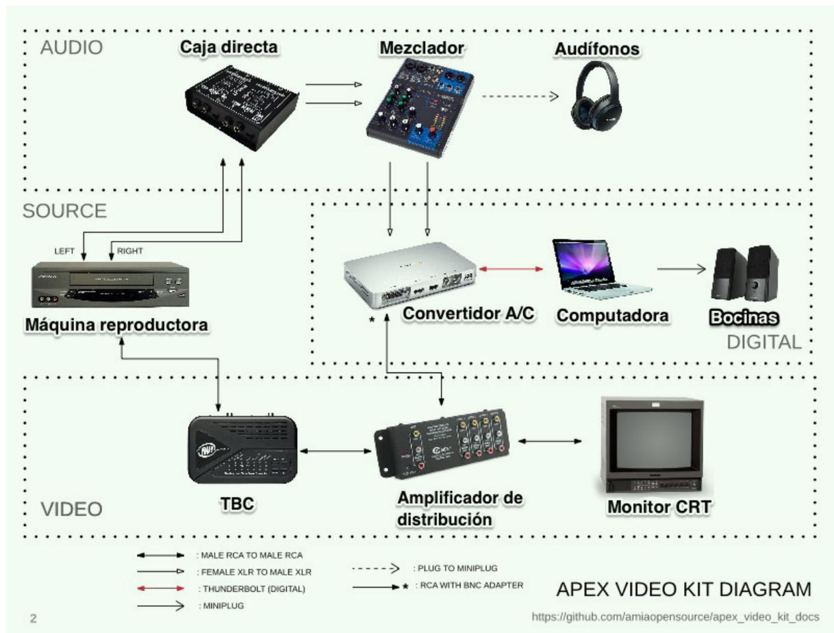
Diagrama de los componentes del kit de digitalización de APEX, útil para proyectos caseros o de menor escala.
